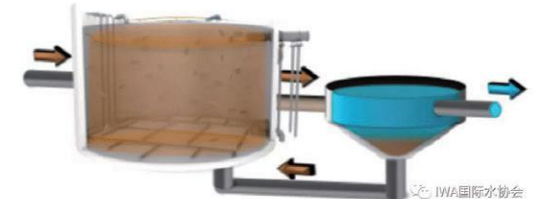
图. IFAS工艺的构造示意图 | 图源: MDPI
